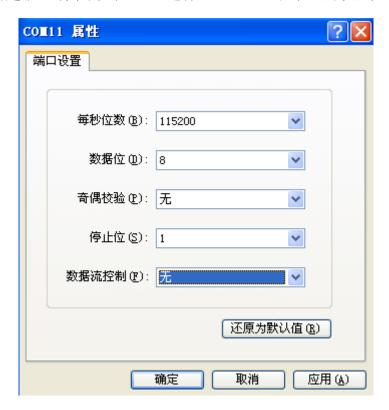
设置好串口后,发送指令"AT"测试,敲入'AT',按回车,得到'OK'。如下所示:
