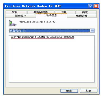
由 USB\VID\_20A6&PID\_1105&MI\_00\6&38D75D1&0&0000 可以得到 vid,pid 和 ttyUSBx 中的 x. 由 MI\_00 可以知道该端口在 Linux 系统对应的串口是 ttyUSB0, 故这个设备的 PPP 口是 ttyUSB0,即 PPP 口为 0 口。
