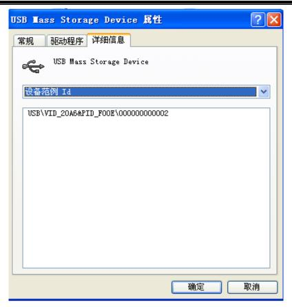
上图 USB\VID\_20A6&PID\_F00E\0000000000002 中的 VID\_20A6&PID\_F00E 表示该设备的 vid=0x20a6, pid=0xf00e. 这里就是 DefaultVendor, DefaultProduct。即:
